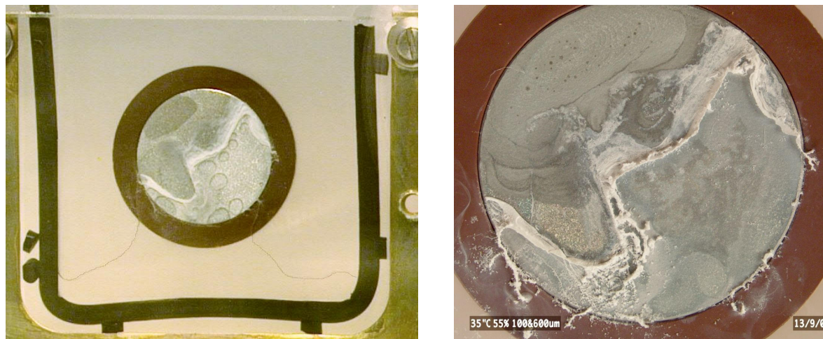
Figure IV-10 : Photographie d'un échantillon en cours d'essai et après démontage de la cellule de corrosion. Conditions d'essai: eau ultra-pure, 35°C, 55%HR durant 48 heures, épaisseurs de cale :100 µm. La précipitation est importante au niveau des lignes d'eau.
