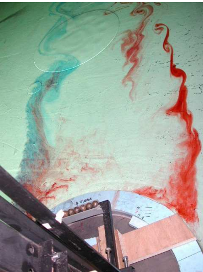
FIG. 4.16 – Couche de cisaillement (a) et allée tourbillonnaire (b) derrière le cylindre pour l'expérience n° 5, Bu = 0.09 et Ro = 0.07 .
