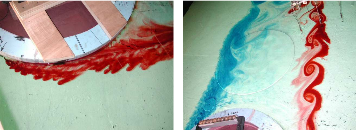
FIG. 4.17 – Couche limite cyclonique (a) et couche de cisaillement derrière le cylindre (b) pour l'expérience n°7, Bu = 0.09 et Ro = 0.21 .
