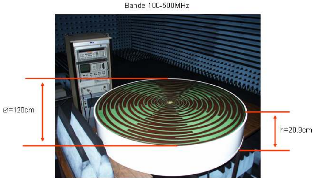
Figure 1.1 Antenne sinueuse bipolarisation placée au dessus d'une cavité absorbante
