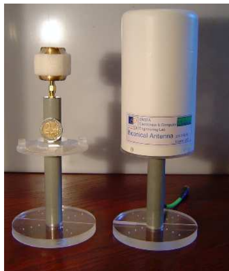
FIG. 3.17: Bicone monté sur son support et ses protections (radôme et coque).
