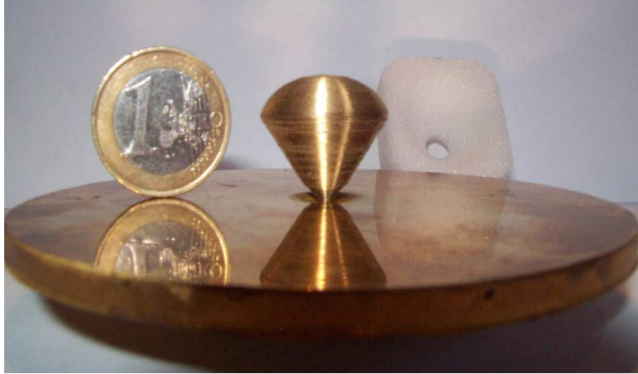
FIG. 3.1: Monocône et son radôme en mousse en arrière plan.
