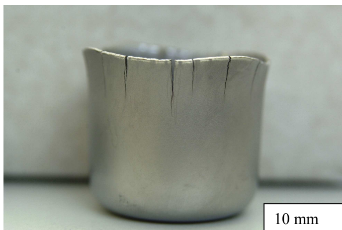
Figure I-5 : Rupture différée dans l'acier austénitique 301LN après emboutissage profond d'un godet à fond plat
