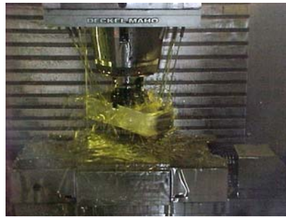
Fig. III-12 : usinage des éprouvettes.
