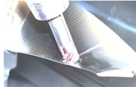
Fig. III-5 : opération de finition de l'aube
