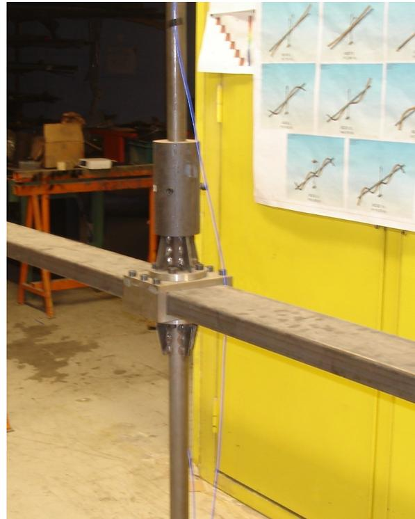
FIG. 6.2 – Liaison centrale de la maquette.
