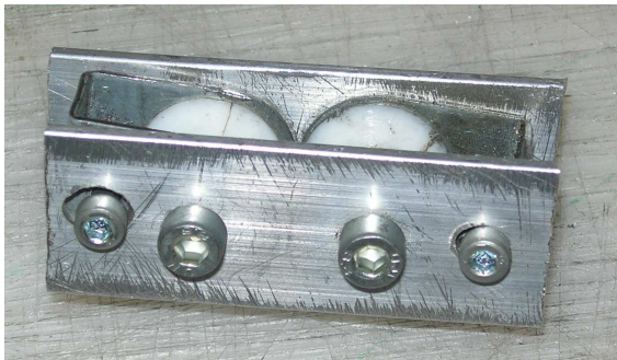
FIG. 4.12. Poulie double pour les nœuds libres
