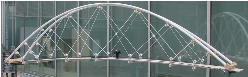
FIG. 2.2. Maquette 1/10 de la passerelle bowstring développée au LAMI
