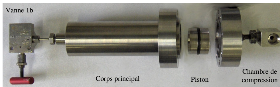
Figure 2.11 : Photo de la cellule de chargement à volume variable
