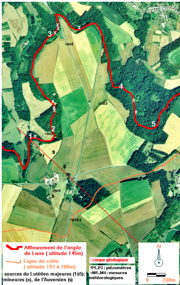
Figure 2.2/3 : Photographie aérienne du site de Bruyères (mission IGN du 20/07/1996). Schéma des limites du bassin et de la localisation des sources et des stations de mesures météorologiques et piézométriques.
