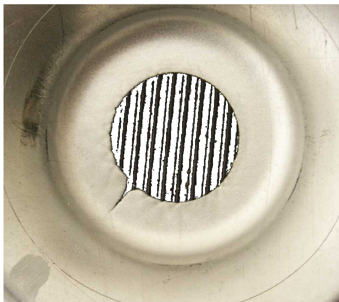
Figure 1.11. Essai d'expansion d'une tôle en acier doux ayant un trou au centre. Apparition de plusieurs bandes de localisation au bord du trou, avec propagation d'une fissure macroscopique selon la direction radiale (3 ème Rapport CECA, VoestAlpine).
