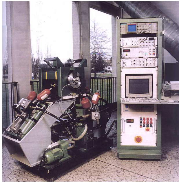
FIG. 2.30 – Machine de flexion et torsion combinées du LAMEFIP.
