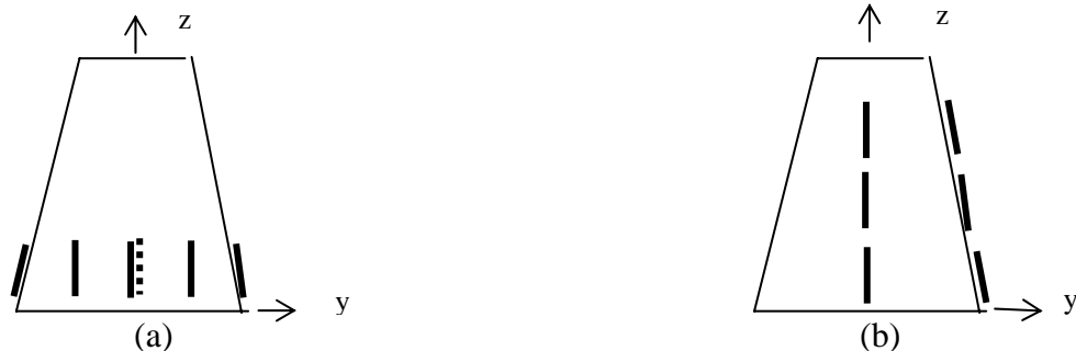
Fig. C2.7 : Configurations de jauges extensométriques sur une éprouvette d'enrobé bitumineux (jauge disposée sur la face cachée représentée en pointillés)
