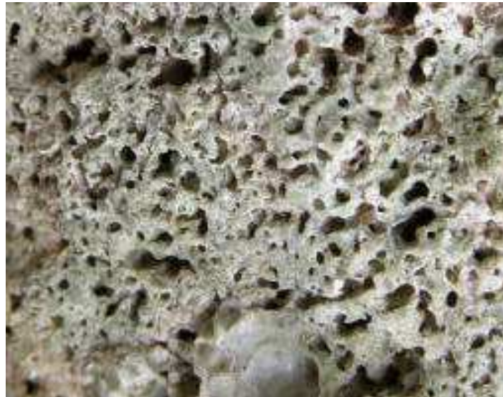
FIG. 2.2 – Exemple de roche poreuse dont il faut estimer et/ou mesurer les propriétés pétrophysiques, en particulier la porosité et la perméabilité
