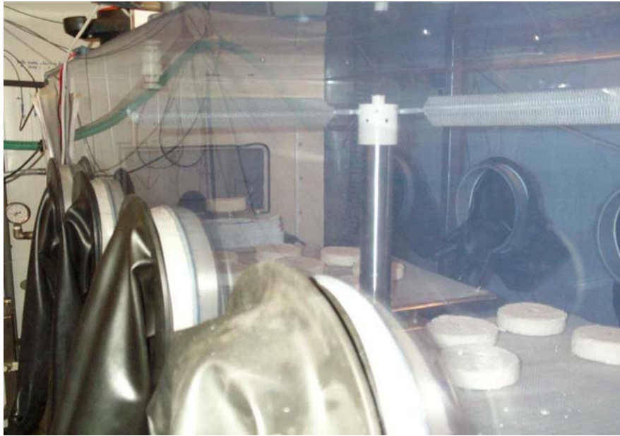
Figure II.2 : photographie de l'enceinte d'affinage des fromages.
