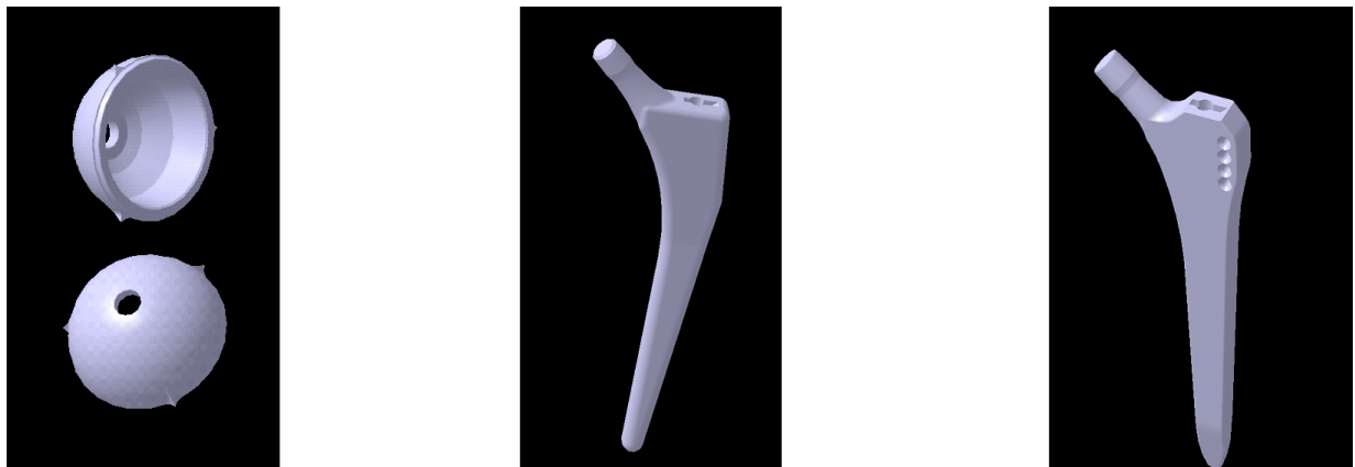
Figure 72 : Modèles CAO réalisés pour la cupule « Concept Delta GR 47 » et les prothèses « Global 12 » et « FTP 2 »
