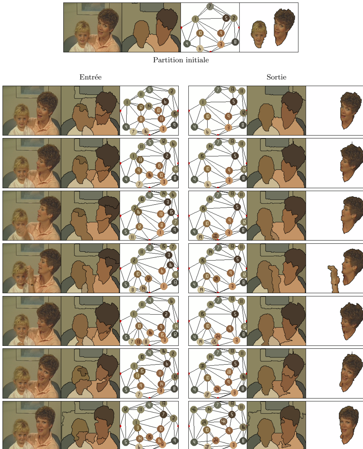
FIG. 7.16 – Séquence « Mother and daughter ». Détails concernant la mise en correspondance de graphes sur les trames : 20, 40, 60, 80, 240 et 280.
