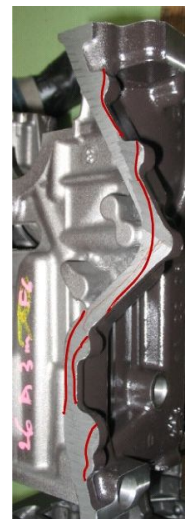
FIG. 2.3 – Pièce usinée avec une profondeur de passe nominale de 3mm. Les zones brouillées sont délimitées par les traits rouges.
