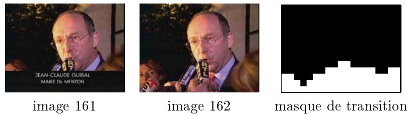
FIG. 3.8: Exemple de masque de transition binaire obtenu dans le cas de l’apparition d’un bandeau de texte (séquence seq9 ).
