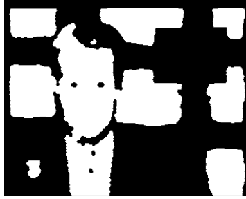
FIG. 5.14: Illustration de la classification pixels de couleur / pixels gris résultant de la transformation HSV améliorée de l'image originale présentée dans la figure 5.10, (a).
