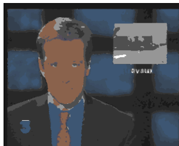
FIG. 5.17: Effet du filtre médian classique sur les zones à niveaux de gris et du filtre médian vectoriel sur les zones couleur.
