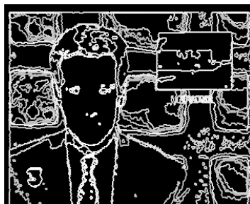
FIG. 5.23: Gradient dans l'espace HSV. On présente des valeurs de gradient renormalisées afin d'en augmenter le contraste.
