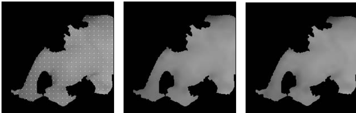
(a) Image originale avec points d'échantillonnage \mathcal{E} (b) Région compressée en utilisant l'échantillonnage simple (EQM=17,1) (c) Région compressée en utilisant l'échantillonnage optimal (EQM=11,5)
