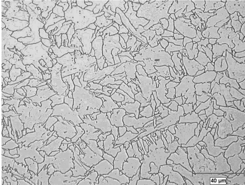
FIG. 3.14 – Microstructure de l’acier ferritique microallié utilisé pour étudier l’influence du rapport de charge sur la dissipation intrinsèque.
