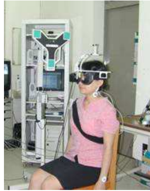
Figure 9. Système Zebris pour mesurer en continu la position de la tête (casque) par rapport au tronc (épaulette).
