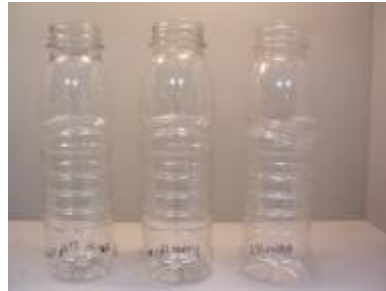
Figure 15. Bouteilles PET1, PET2 et PET4 (de la gauche vers la droite) ne montrant aucune différence visuelle entre les matériaux plastiques utilisés (la bouteille de PET3 non photographiée est similaire)
