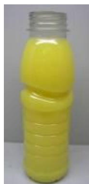
Figure 32. Une bouteille de PET2 (Bindox®) juste après le remplissage du jus au temps t_0
