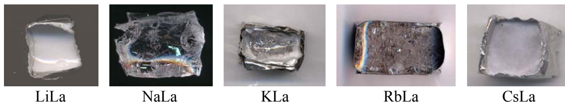
Figure 40: Photos des verres de la série alLa ayant subi une descente lente en température (1°C/min) depuis l'état fondu (1350°C).
