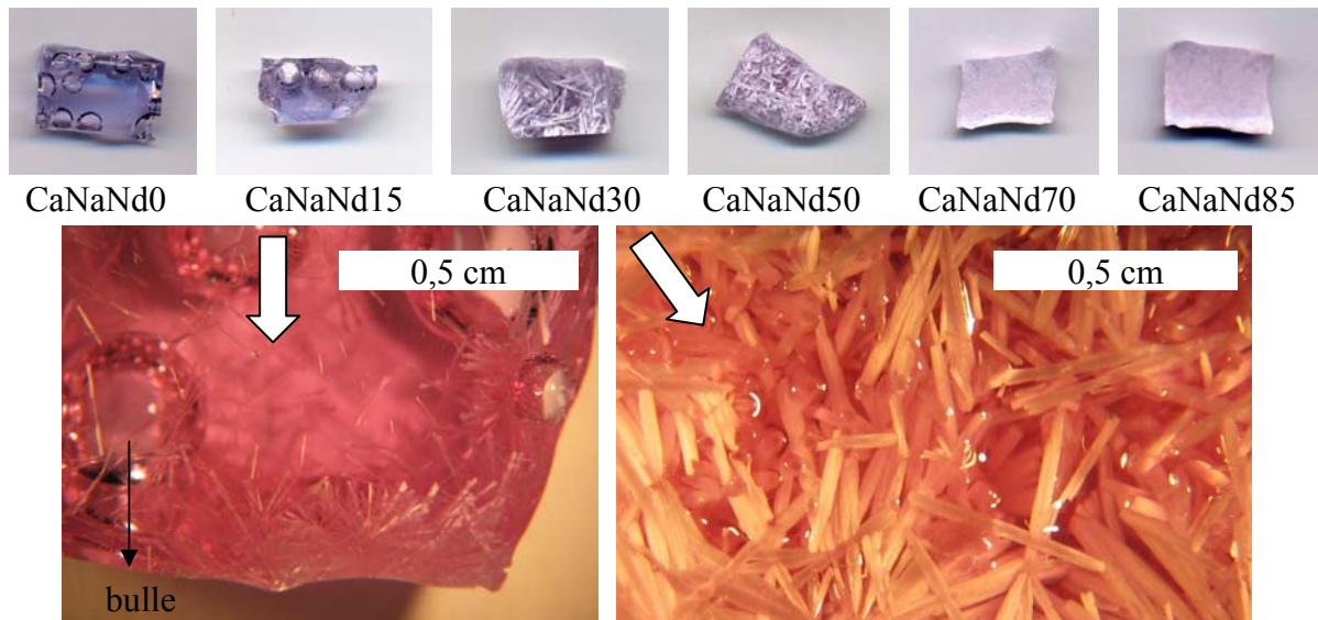
Figure 34: Photos des verres CaNaNdx ayant subi une descente lente en température (1°C/min) depuis l'état fondu (1350°C) et agrandissements à la loupe binoculaire des échantillons CaNaNd15 et CaNaNd30 mettant en évidence les cristaux d'apatite. Les bulles observées pour les échantillons riches en sodium (formées au fond du creuset de Pt-Au) sont attribuables à des phénomènes électrochimiques consécutifs à une légère évaporation de sodium à la surface du liquide fondu ou surfondu [60].
