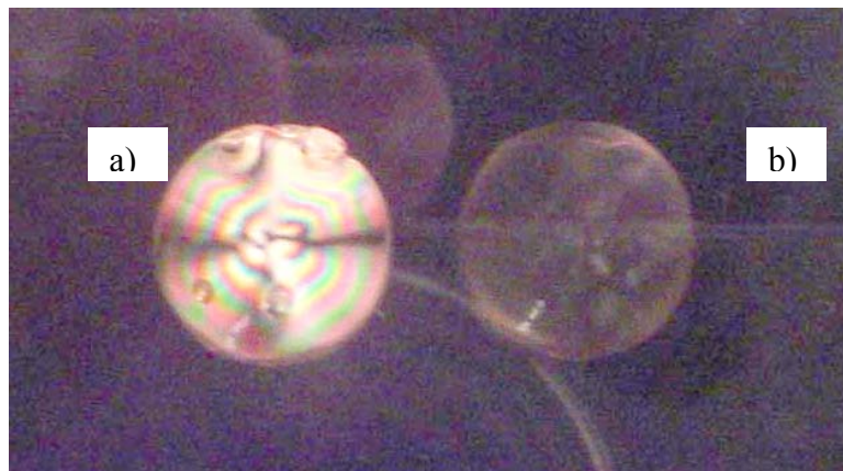
Figure 3 : Photos de verres avant recuit (a) et après recuit (b) observés sous polariseurs croisés. Les irisations visibles sur l'échantillon de gauche non recuit témoignent des contraintes qui règnent dans le plot de verre (lors de la trempe, la surface de l'échantillon se refroidit plus vite que le cœur ; le volume molaire du verre en surface est donc plus grand que celui au cœur du plot ; la surface du plot est donc en compression et le cœur en extension). Le recuit permet d'éliminer les contraintes mécaniques emmagasinées lors de la trempe en rendant l'échantillon homogène.
