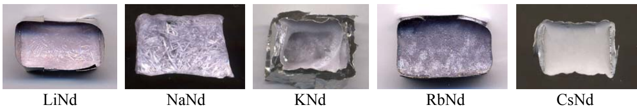
Figure 30: Photos des verres de la série alcNd ayant subi une descente lente en température (1°C/min) depuis l'état fondu (1350°C). Le verre NaNd correspond au verre de référence A.
