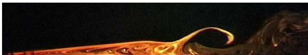
FIG. 3 – Représentation expérimentale du IAG à Stuttgart de la configuration étudiée au cours de ce mémoire. La très forte instabilité liée au bulbe laminaire induit la présence de structures tourbillonnaires en aval de la bulle.
