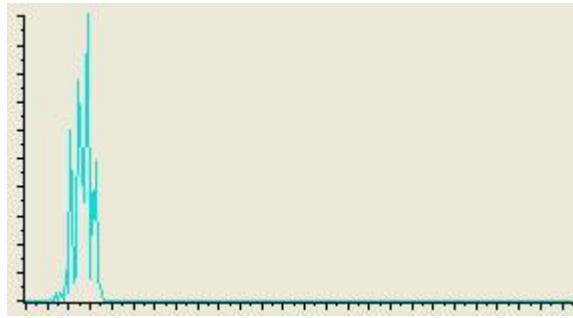
FIG. 4.12 – Histogramme de teinte de la figure 4.10. En abscisse la valeur de la teinte (de 0 à 255), et en ordonnée, le nombre de pixels.
