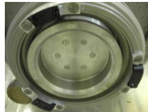
(c) Fonction de mesure du frottement : patins de mesure
