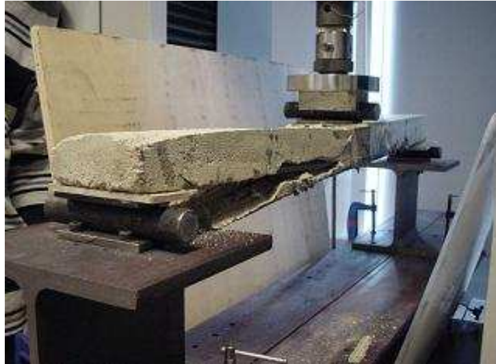
FIG. 9.20. Mode de ruine de la poutre 3 de (Limam et al., 2003a)
