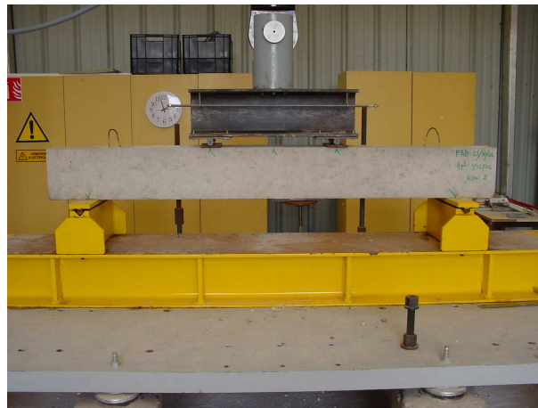
FIG. 9.4. Expérience de flexion 4 points.
