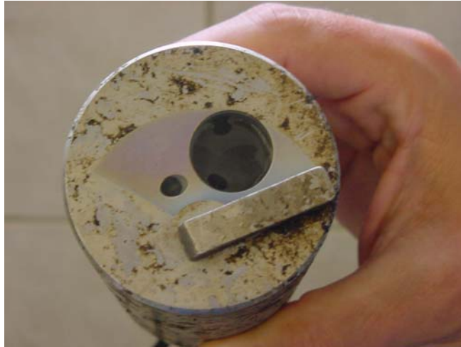
Figure 63 : Photographie de la sonde Dr Lange après la campagne des essais
