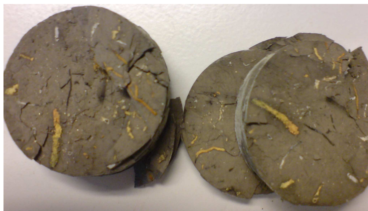
Figure 5- 23. Echantillons après l'étuvage à 105 °C. A gauche : après une semaine dans l'étuve (échantillon après essai 10) ; à droite : après un mois dans l'étuve (échantillon après essai 9)
