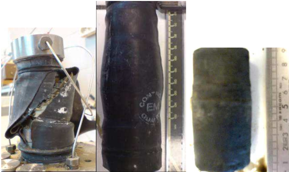
Figure 5- 19. Echantillons au démontage après le cisaillement. A gauche : l'échantillon cassé après l'essai 16 ; au milieu : l'échantillon en forme de tonneau après l'essai 13 ; à droite : l'échantillon en forme de tonneau après l'essai 7.
