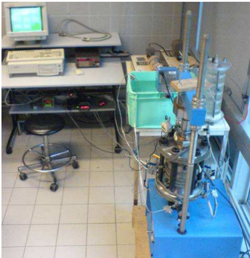
Figure 2- 26. Cellule triaxiale sous presse. De gauche à droite : système d'acquisition, deux GDS, bain thermostat, cellule sous presse
