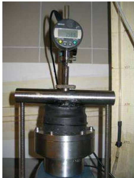
Figure 2-18. Cellule oedométrique avec mesure de succion
