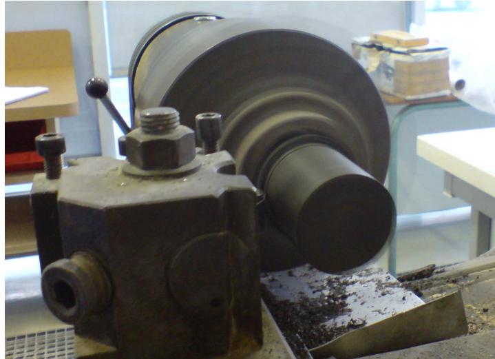
Figure 2- 3. Tour utilisé pour confectionner les échantillons de sol
