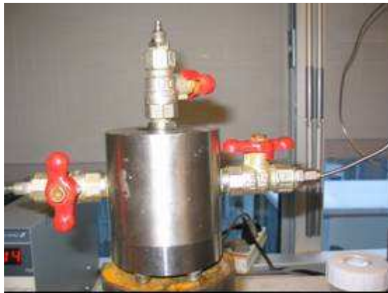
Figure 2-11. Schéma du tensiomètre (Mantho, 2005)
