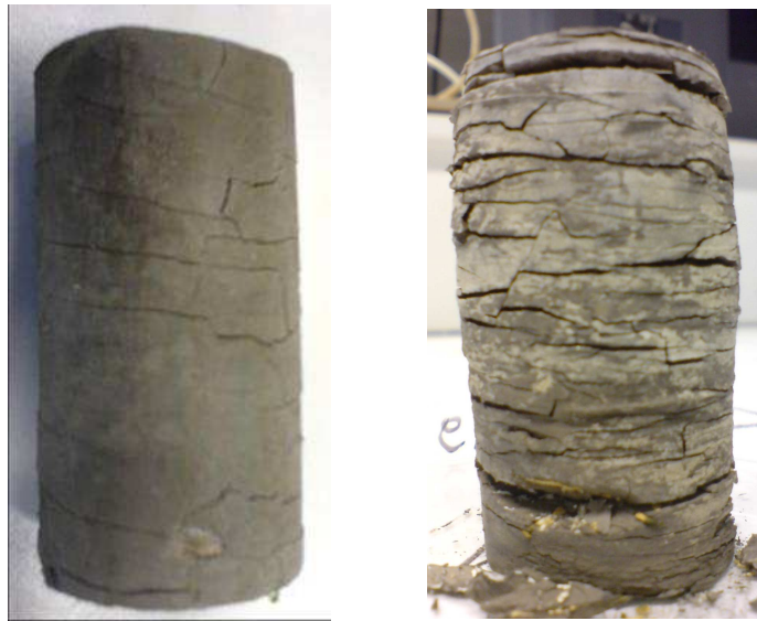
Figure 5- 23. Echantillons après l'étuvage à 105 °C. A gauche : après une semaine dans l'étuve (échantillon après essai 10) ; à droite : après un mois dans l'étuve (échantillon après essai 9)
