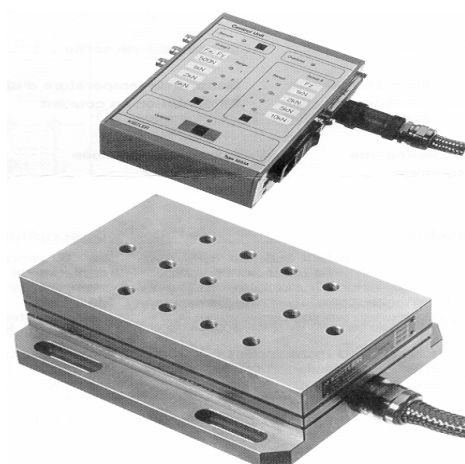
Figure A. 6 : Table Kistler 9257-B et boîtier d'acquisition [Kistler, 2003].
