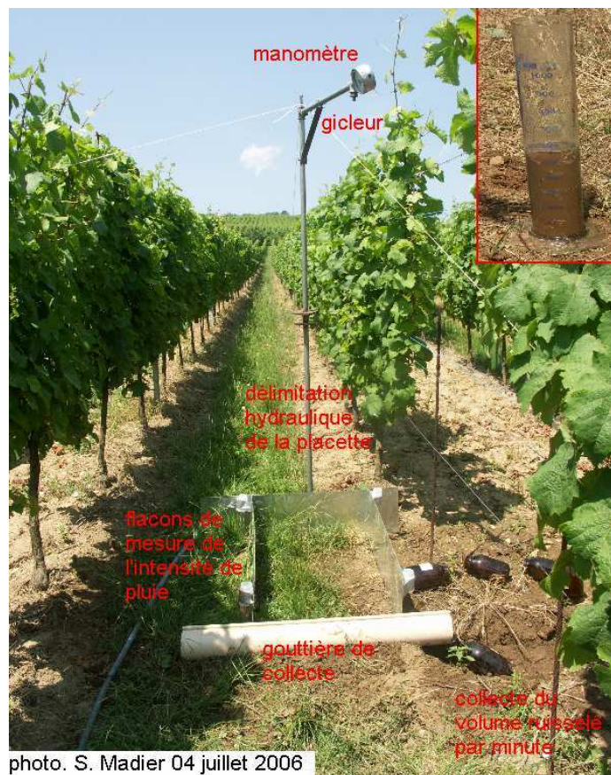
Figure 3- 43 Instrumentation des placettes de mesure dans le cadre de la campagne de simulation de pluie menée les 4, 5 et 6 juillet 2006 sur le bassin versant de Rouffach (Haut-Rhin, France), d'après l'instrumentation de Armand et al. (2007, soumis).
