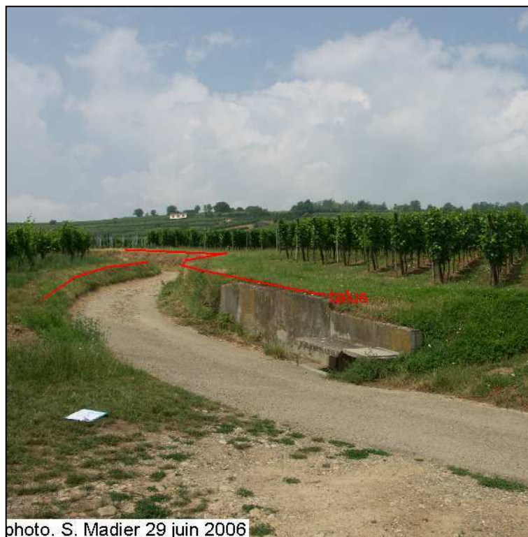
Figure 3- 2 Obstacles à la connexion parcelle/route : talus et connexions enherbées concaves. Campagne de terrain du 29 juin 2006 avant l'orage. Bassin versant de Rouffach (Haut-Rhin, France).
