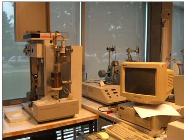
Figure II-34 Dispositif expérimental: Porosimètre à mercure FISONS 2000
