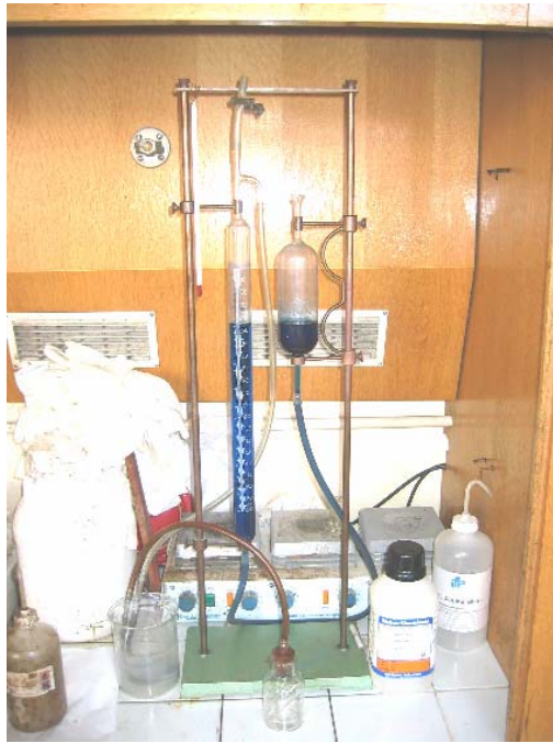
Figure II-27 Dispositif de calcimètre Dietrich Fruhling
