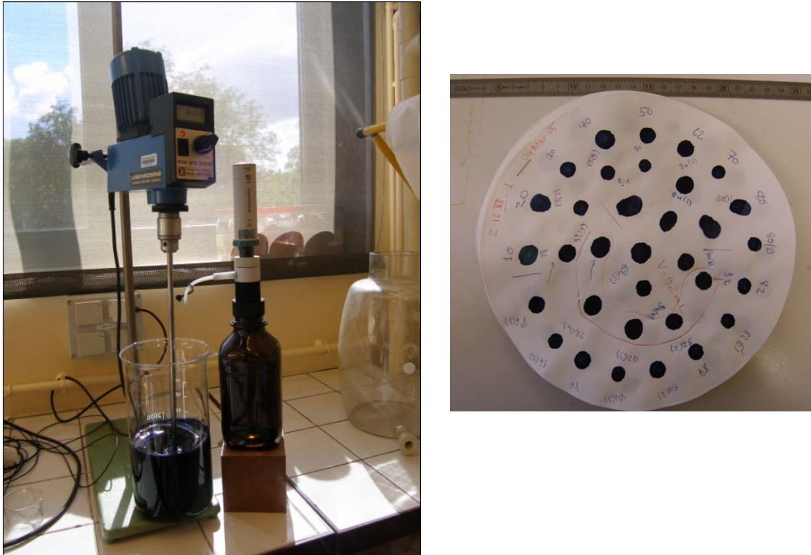
Figure II-29 Dispositif des mesures de valeur de bleu de méthylène
