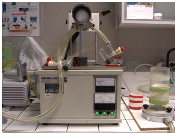
Figure II-32 Dispositif de lyophilisation (CERMES)
