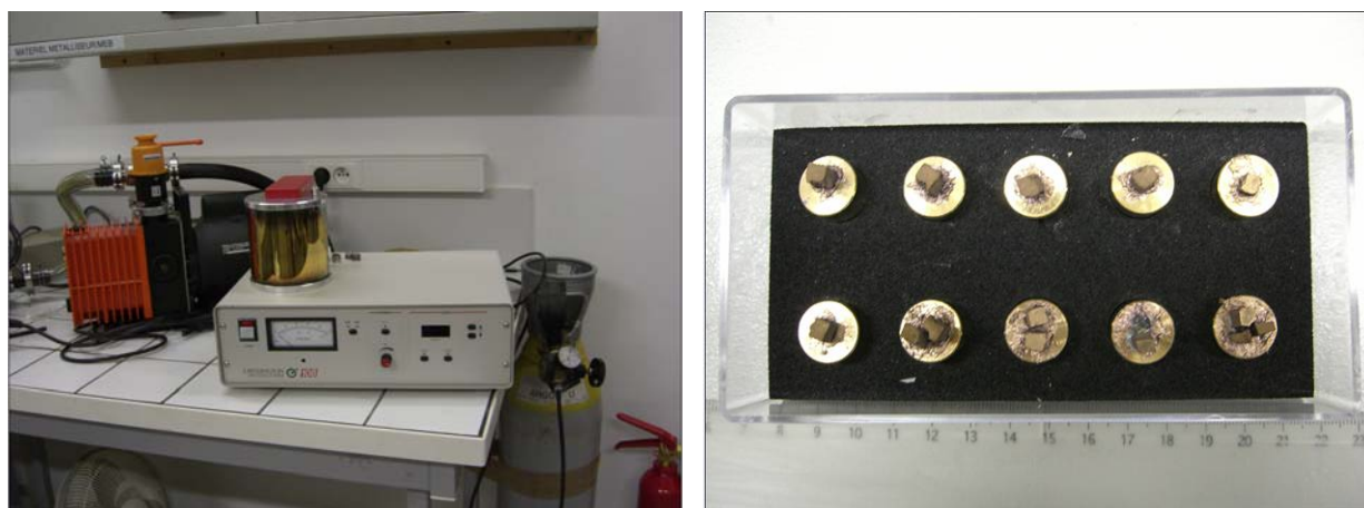
Figure II-33 Dispositif de métallisation (ENPC) et les échantillons métallisés.
