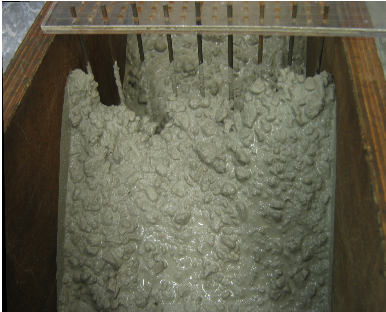
Figure 7.24: Blocage dû au seuil d'un BAP ( d_{max} = 12,5 \text{ mm} ) de 51 Pa au droit d'un ferrailage d'écartement e = 19 \text{ mm}
