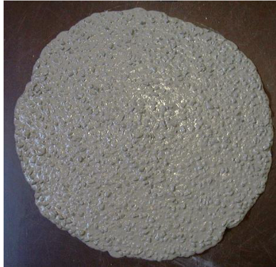
Figure 3.2: Exemple d'une "galette" de béton au cône d'Abrams
