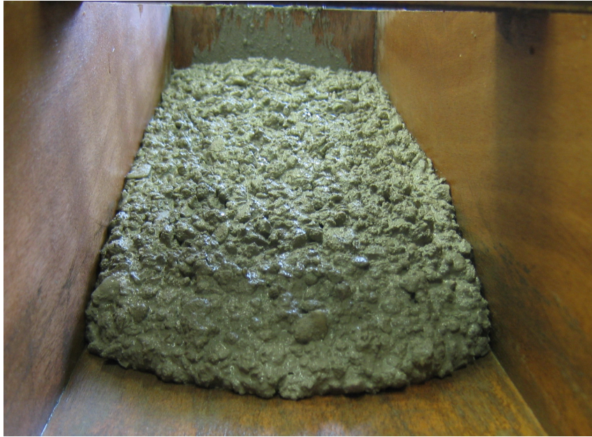
Figure 6.9: Essai d'étalement en canal pour mesurer le seuil d'écoulement d'un béton
