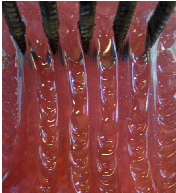
Figure 5.12: Ecoulement de Carbopol à travers un ferrailage élémentaire (FE a14e18,5).
