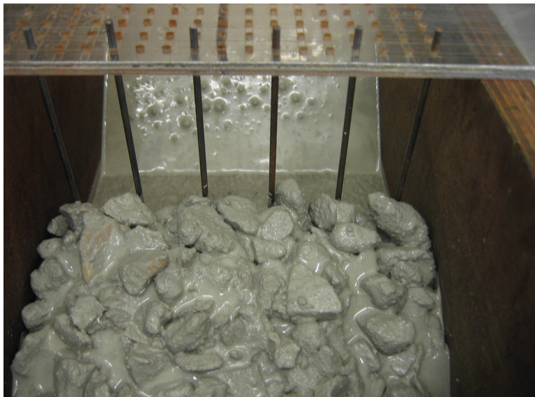
Figure 7.25: Blocage granulaire d'un béton autoplaçant ( d_{max} = 20 \text{ mm} ) au droit d'un ferrailage d'écartement e = 30 \text{ mm}
