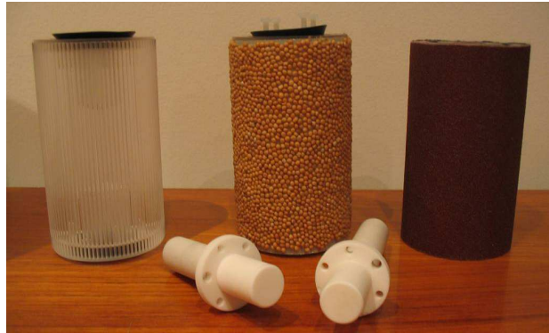
FIG. 5.4 – Les trois cylindres rugueux : strié, graines collées et papier de verre collé. Au premier plan, les axes céramiques des cylindres.
