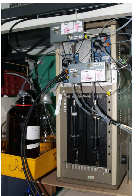
FIG. 6.3: Vue détaillée de l'automate de régulation des solutions nutritives : Pousse-seringues et vannes de distribution de solutions-mères.
