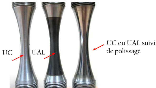
Fig. 92 – Epreuves de traction en 100Cr6 (Cr, Crul, Crp ou Crulp).
