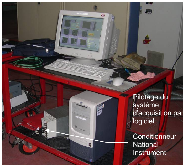
Figure II.41: Système d'acquisition PCI6024E 8 voies National Instrument de l'ENSAM
