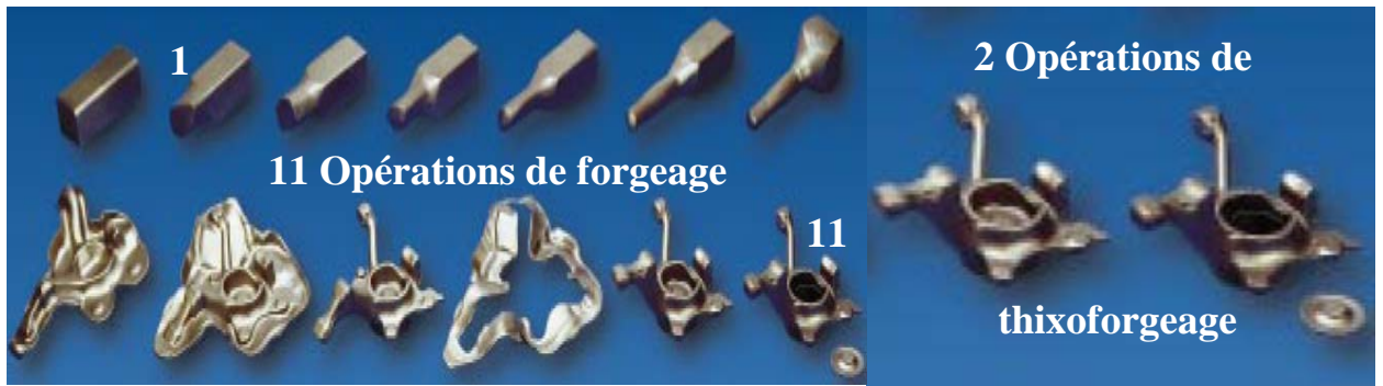
Figure 1 : Comparaisons des étapes de mise en forme entre forgeage et thixoforgeage [1]
