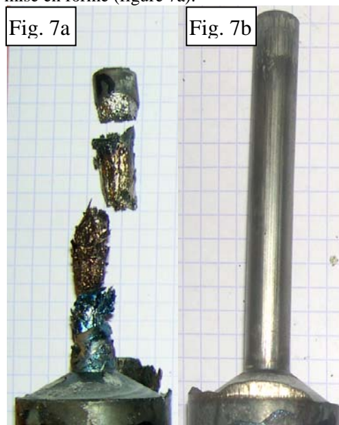
Figure 7 : Ecoulement hétérogène (a) ; Ecoulement homogène (b) [15, 16]
