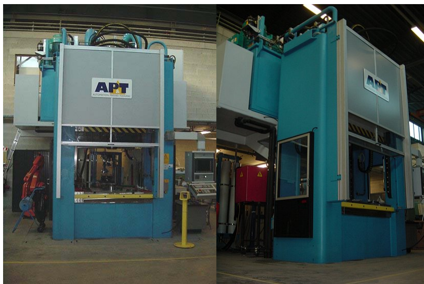
Figure II.15: Presse hydraulique de l'université de Liège LPS 5000-13/10 de la marque AP&T
