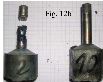
Figure 12 – Comparaison des efforts de filage (a) et des écoulements (b) pour deux cycles de chauffe différents et vitesses différentes
