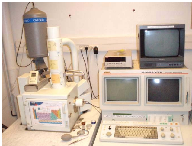
Figure II.47: Microscope électronique à balayage JEOL JSM-5800LV.
