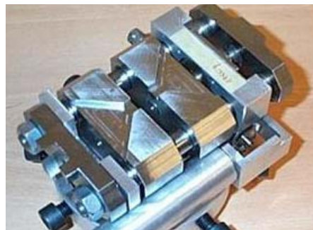
Figure 2.9 : Machine de traction in-situ du LPMM de 5 kN
