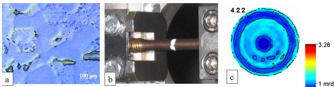
Figure 2.34 : a/ Microstructure de l'éprouvette cylindrique à petits grains EC1, b/ Cette même éprouvette dans le système de traction, c/ Figure de pôles \{442\} mesurée par neutrons
