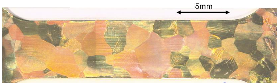
Figure 2.33 : Photo macroscopique de l'éprouvette plate à grains millimétriques EP3
