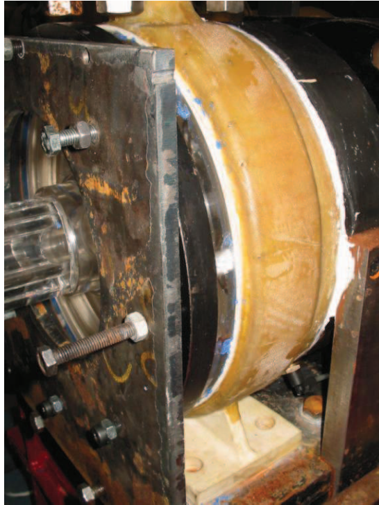
Figure 5-10 : Photographie du système de serrage
