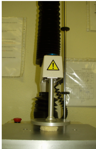
Figure 33 : Test de compression (TAXT2)
