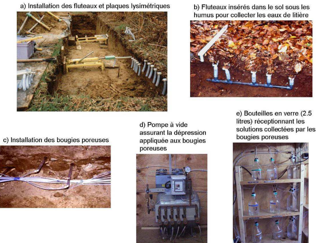
Figure III.4 : Illustrations des différents lysimètres installés dans les sites ateliers de la chronoséquence de Fougères pour collecter les solutions de litières et les solutions de sol.
