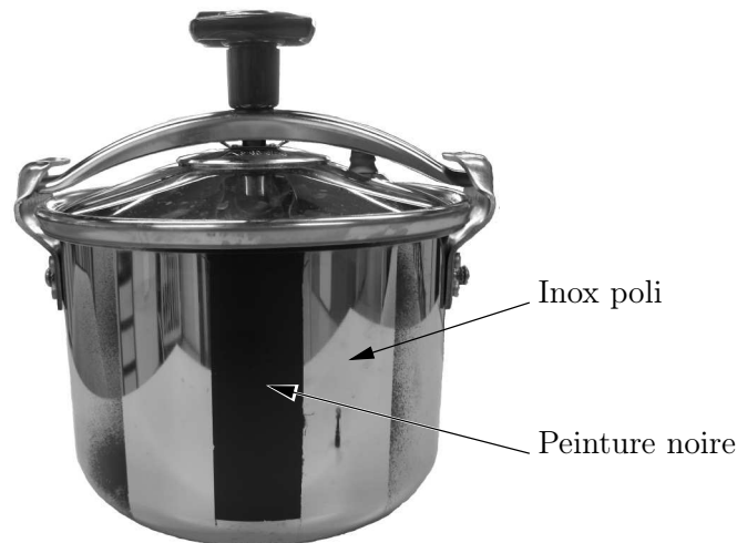
FIG. 3.10 – Autocuiseur peint d'une bande noire pour la mesure de température par caméra thermique
