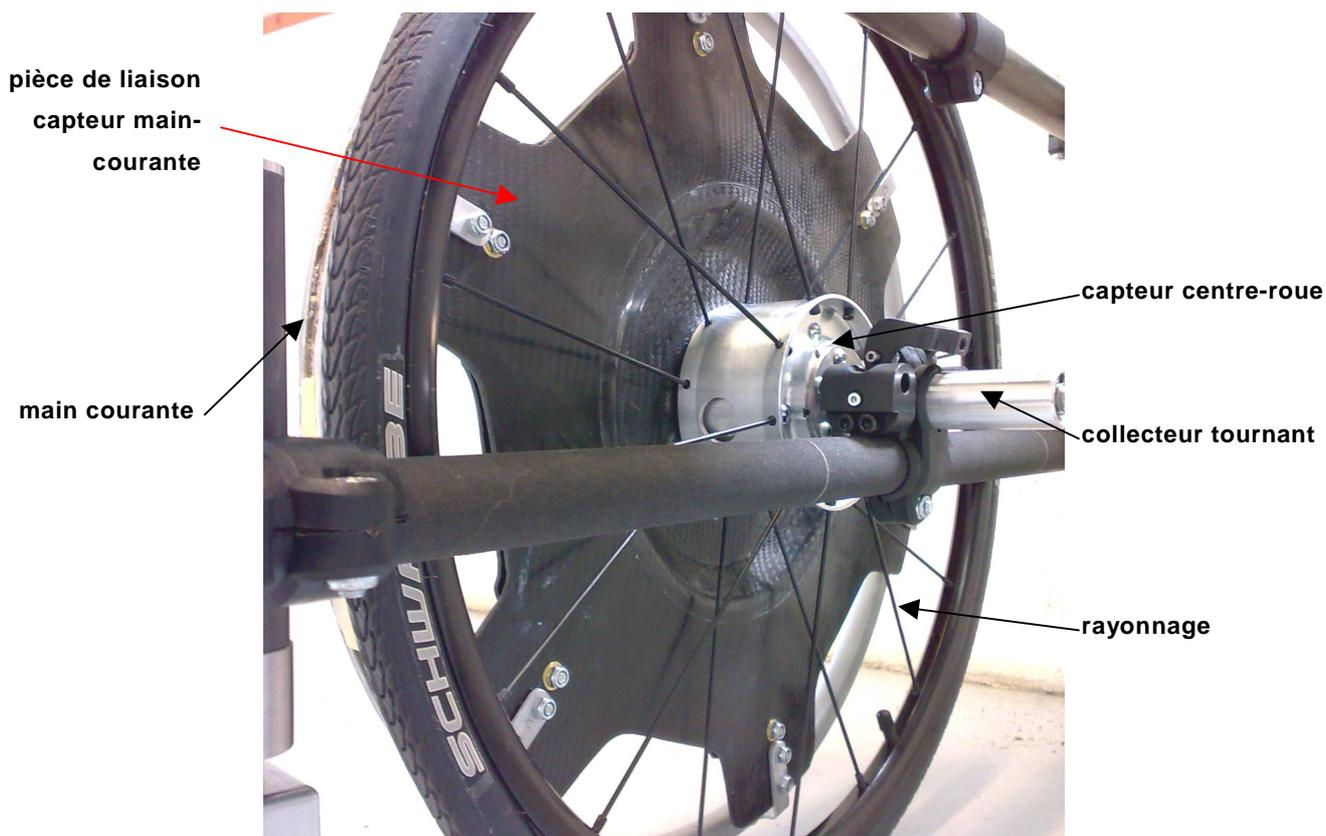
Figure 67 : Photo de la roue droite de CERAHFIT en vue côté intérieure
