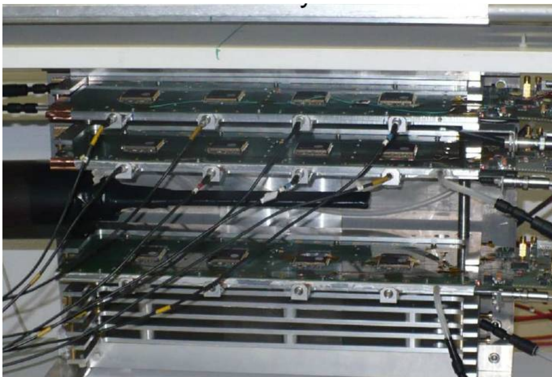
FIGURE 3.23 – Vue de l'installation réalisée pour les tests avec des cosmiques. On voit au milieu des cartes un des scintillateurs utilisés pour réaliser le déclenchement de la prise de données.
