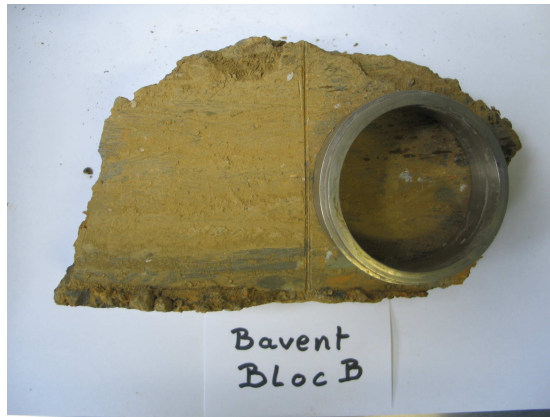
(a) Découpage des échantillons de taille proche de celle de la bague
