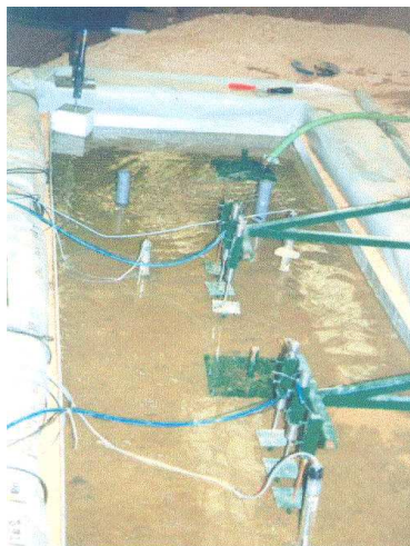
Figure 3.9. Humidification du remblai R1
