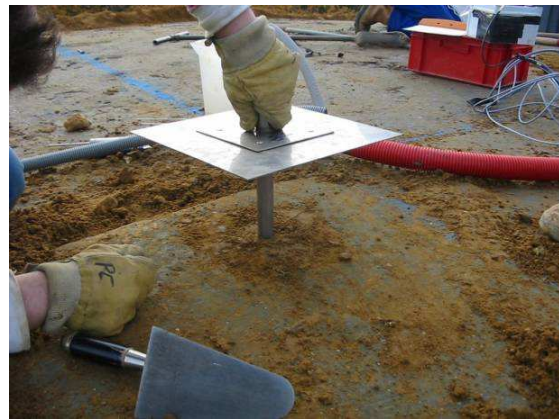
d) mise en place du capteur pour le déplacement vertical
