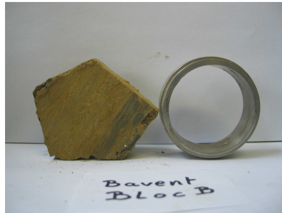
(a) Découpage des échantillons de taille proche de celle de la bague
