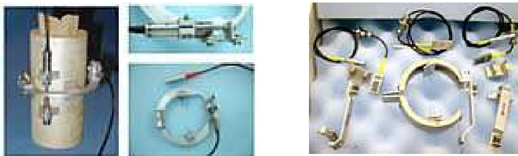
Figure 6.5. Capteurs locaux de déformation et leur montage autour de l'éprouvette
