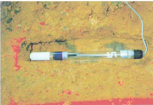
c) Tensiomètre pour mesurer la pression interstitielle
