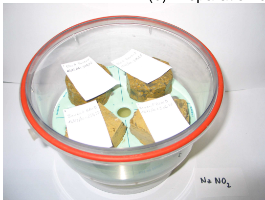
(c) Mise en place des échantillons dans le dessiccateur
