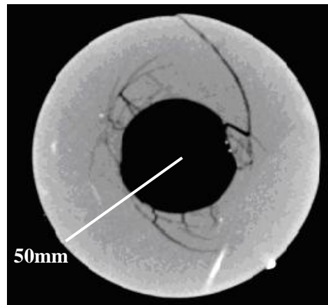
Figure 2.5 - Observation au scanner médical d'une éprouvette tube épais après essai [VAL 03].
