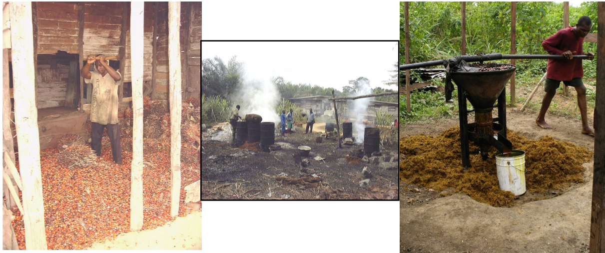
Photos 14, 15 & 16 (S. Rafflegeau) : L'effritage des régimes (à gauche), la cuisson des fruits et une vue générale du chantier de traitement artisanal (au centre) et l'extraction de l'huile avec une presse manuelle verticale de type « Caltech » (à droite).
