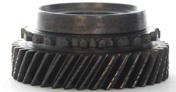
FIG. 3.5 – Vue de côté d'un pignon fou de la 5 ème vitesse de la boîte J. Les crabots ainsi que le cône de synchronisation constituent la partie supérieure.
