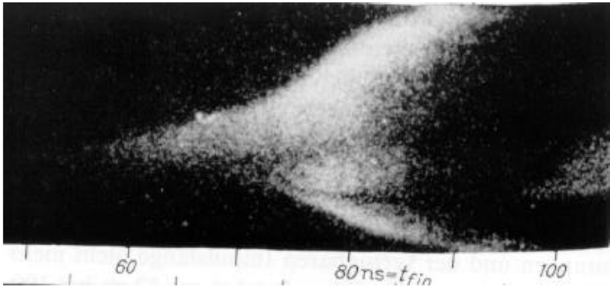
Figure 8 : Propagation de streamers positifs et négatifs obtenus par streak camera, en décharge plan-plan. L'anode se situe au dessus de l'image, la cathode en dessous. Gaz : N_2 à 378 Torr, gap de 30 mm [Wagner 67].
